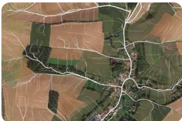
Définition des axes de ruissellement grâce à l'outil Watersed sur le bassin versant de Lacres- Rollez
